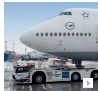
1./3. Im Rahmen der Aktion „Ein Airbus speckt ab“ wird im Dezember 2012 eine A340-300 nach einem Flug vollständig ausgeräumt. Jeder Gegenstand, der nicht fest verschraubt ist, wird erfasst. 2. Ein Betankungsvorgang. 4. Mitglieder des Projektteams von Fuel Efficiency in einem Meeting. 5. TaxiBot-Testlauf: Mit Hilfe des neu entwickelten Schleppers TaxiBot bewegt der Pilot das Flugzeug ohne laufende Triebwerke bis zur Startbahn, Kosten und Umweltbelastung werden signifikant reduziert.
